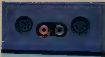
◆カセットとテレビ用のコネクタ。コネクタとは、複数の電気回路を結んだり、離したりする機械部品のことである
